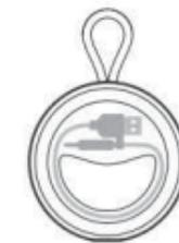
Stecken Sie zuerst das USB-Kabel in die Basis.
